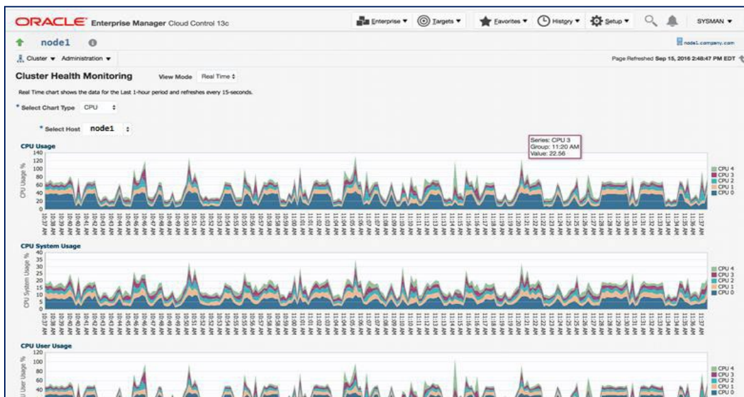
図5：CPU使用率、CPUシステム使用率およびCPUユーザー使用率に分類されたCluster Health MonitorのCPU使用メトリック
