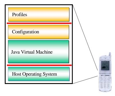
Figure 1-3 J2ME software layer stack
