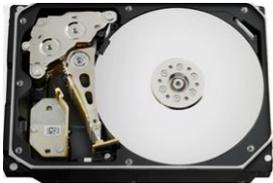
磁気ディスクをメインとしたデータストレージでは、シークの発生によりランダムI/Oの性能に限界
