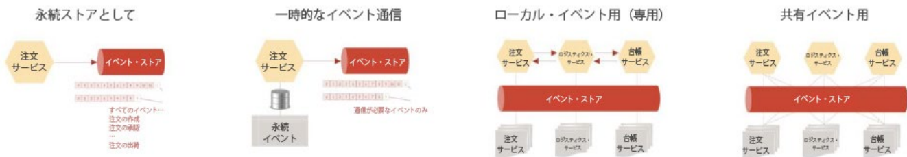
図35：イベント・ソーシング・パターンがマイクロサービス・アーキテクチャで使用される異なる方法
