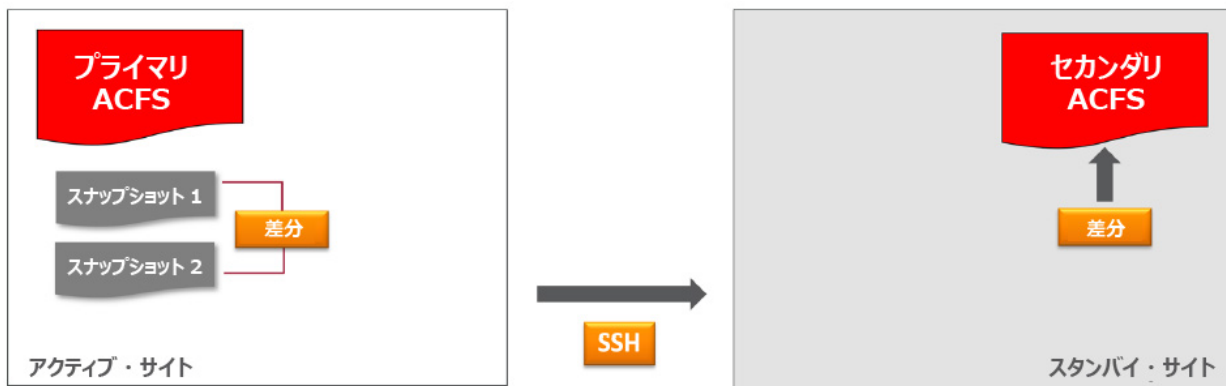
図8：Oracle ACFSスナップショットのレプリケーション用ストレージ要件
