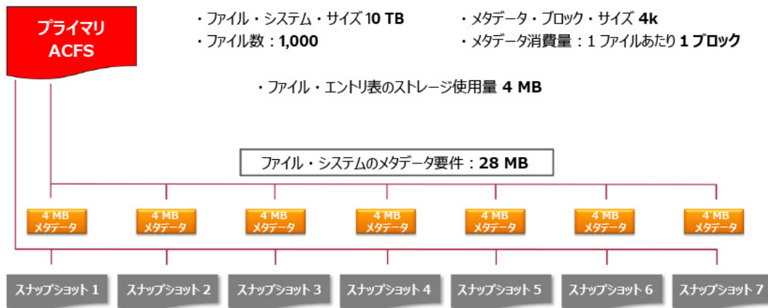
図5: Oracle ACFSスナップショットのメタデータ・ストレージ要件
