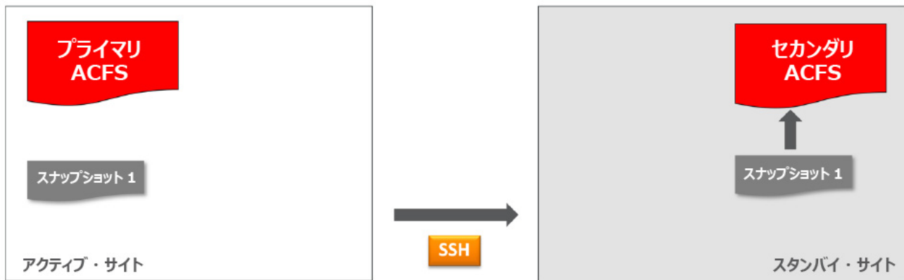
図7：Oracle ACFSスナップショットのレプリケーション用ストレージ要件
