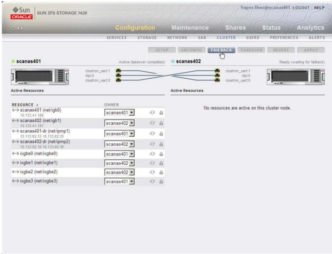
図17：所有ノードに対するクラスター・リソースのフェイルバック
