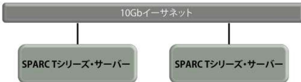
図2: もっとも基本的な物理アーキテクチャ構成 (ペアのSPARC Tシリーズ・サーバーで構成)。実証の目的で、T5-2をおもな例として使用。
