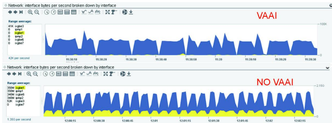
図17 : Oracle ZFS Storage Appliance Analytics - VAAI for NASプラグインが有効な場合および無効な場合のオフロード操作 - ネットワーク : インタフェース別に分類した1秒あたりのインタフェース・バイト数
